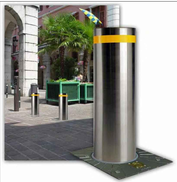
Dissuasore a scomparsa completo di pistone e centralina oleodinamica con blocco a chiave per abbassamento manuale dal diametro della colonna di cm 20 e corsa pistone di cm 50.
