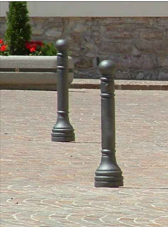
Dissuasore fisso a colonnina realizzato in ghisa sferoidale zincato a caldo, di altezza cm 90 e diametro alla base di cm 20.
