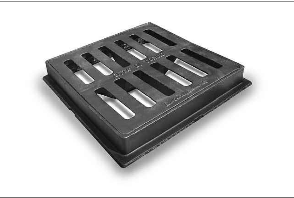
Caditoia concava in ghisa sferoidale, costituita da telaio di forma rettangolare della dimensione di cm 40x50, da posizionare lungo la zanella ovalizzata disposta per lo scorrimento delle acque superficiali, predisposta per evitare il furto e la manomissione.
